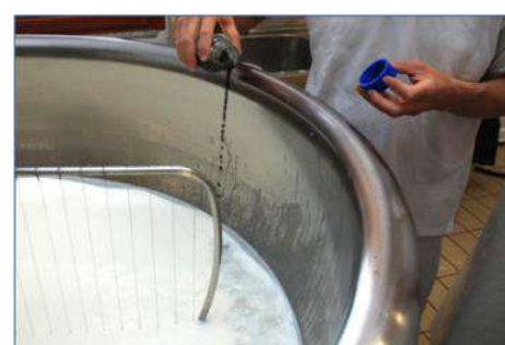
Aggiunta della sospensione di spore di Penicillium roqueforti
