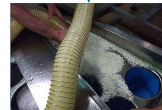
Trasferimento della cagliata negli stampi di formatura
